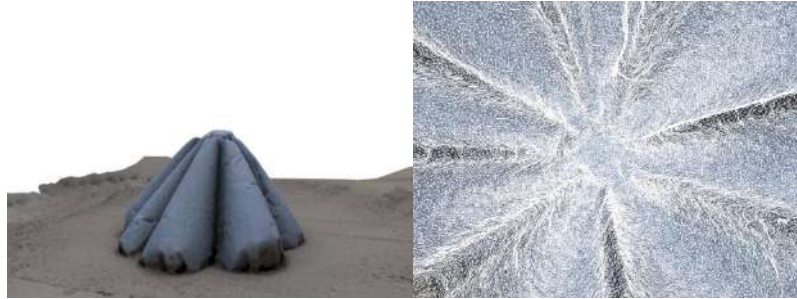
Şekil 19. (Sol) Fotogrametri yöntemiyle üretilen üç boyutlu beton blok modeli. (Sağ) Modelin Rhino ortamındaki yüzey dokusu, mesh wire.
