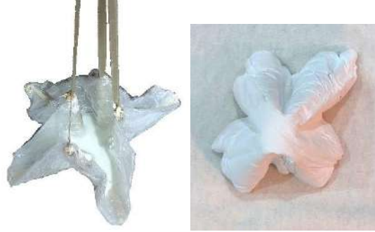
Şekil 17. (Sol) Kare tabanlı katlanabilir kalıba beton dökümü. (Sağ) Üretilen beton blok.
